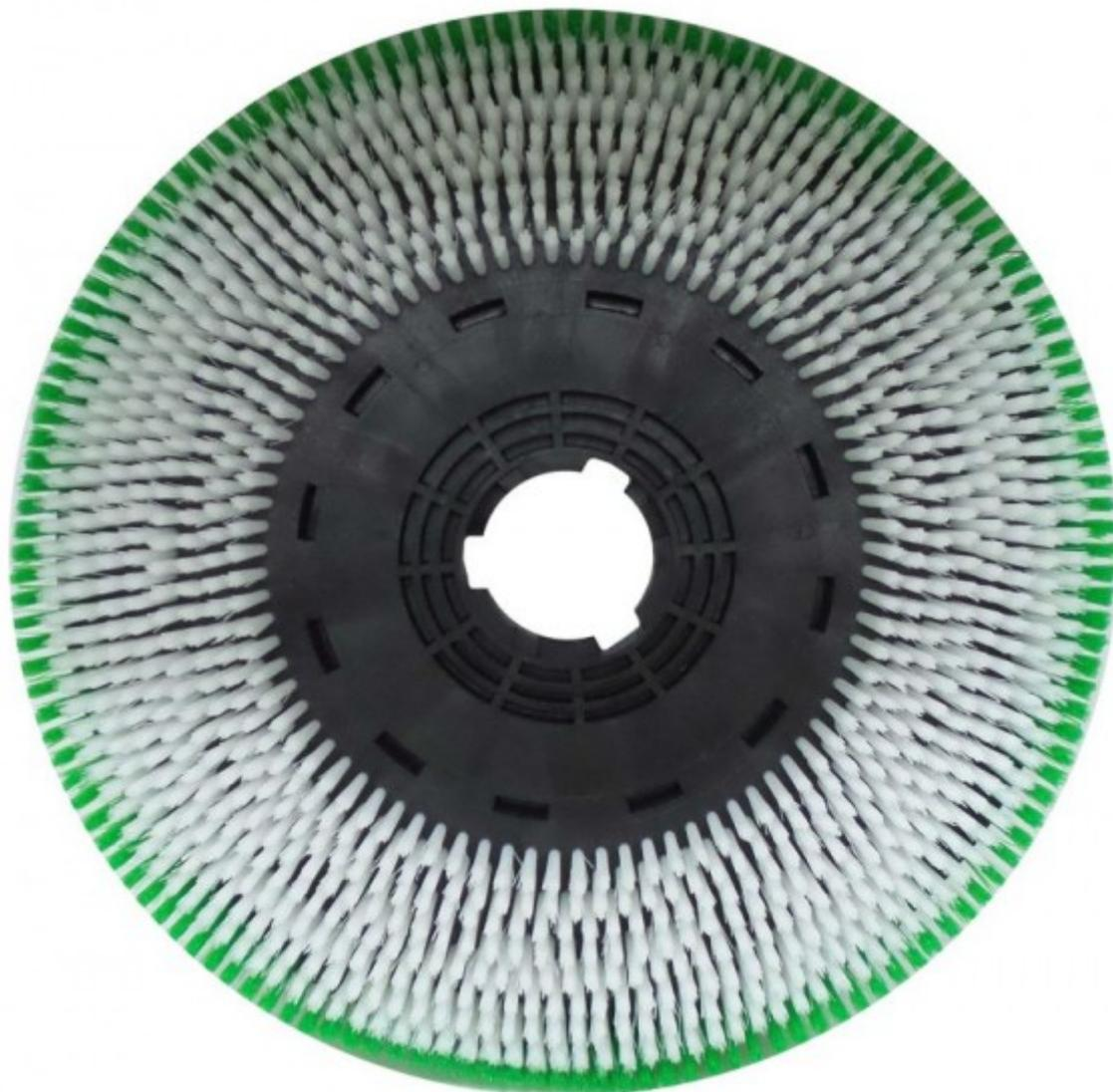
Дисковая щетка для поломоечных машин Numatic TT 6650. Данная щетка имеет щетину средней жесткости, что подходит для подавляющего большинства поверхностей (от промышленного линолеума до керамогранита). Щетинки изготовлены из полипропилена, толщина каждой из них 0,6мм. Щетинки крепятся к основанию щетки под определенным углом таким образом, чтобы щетка лучше захватывала области рядом со стеной.
